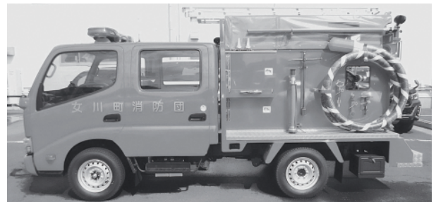
桐ヶ崎班小型動力ポンプ付積載車
