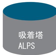
吸着塔との間を何度か循環させるとトリチウム以外の複数の核種は取り除かれる
